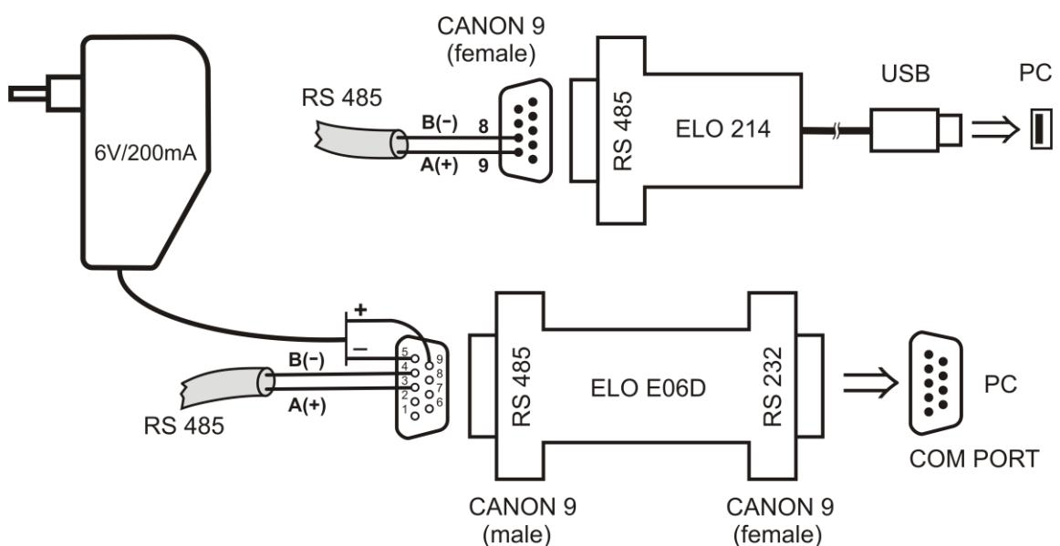
Pro připojení snímače s rozhraním RS485 k PC přes sériový port RS232 je jako volitelné příslušenství nabízen převodník **ELO E06D**. Konektorem označeným RS232 se připojí přímo do PC, na konektoru označeném RS485 se na vývod č.9 připojí napájecí napětí +6V DC z externího adaptéru, na vývod č.5 se připojí 0V a na vývody č.3 A(+) a č.4 B(-) se připojí sběrnice RS485. Časová prodleva je možné nastavit pomocí propojek na konektoru označeném RS485. Podrobné informace jsou v návodu k převodníku.
